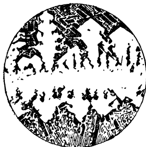
Рис. 142. Сплав меди и магния под микроскопом (увелич.—110).
