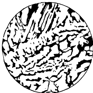
Рис. 143. Сплав меди и цинка под микроскопом (увелич.—44).
